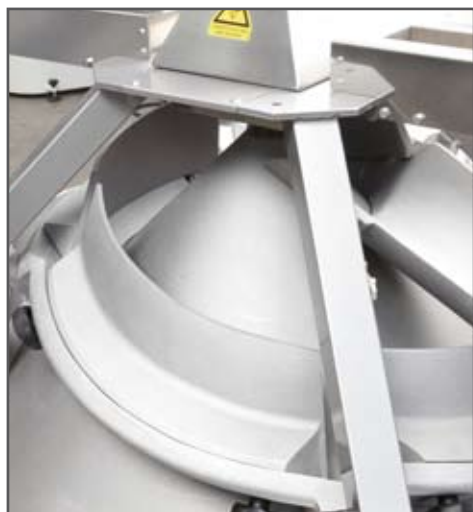
Canali aperti per produzione da 500 a 1400 g. Rounding channels open for production from 500 to 1400 g.
